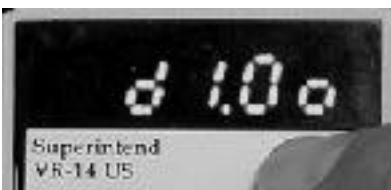
Bild 3.3.5 Inställningsvärdet är för lågt, vrid potentiometern en aning medsols
